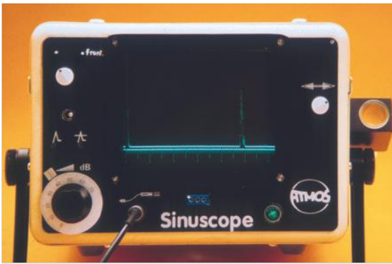
Abb. 1.4 Spezielles A-Mode-Sonografiergerät zur Untersuchung der Nasennebenhöhlen im Jahre 1975. Verwendet wurden ein Gerät der Fa. ATMOS (Lenzkirch) und 5-MHz-Schallköpfe.
